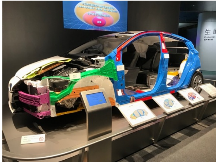
外装が取り外され、フレームが見える状態で展示されている自動車。色が異なるフレームは、強度特性が異なるハイテン・超ハイテンが用いられています。(トヨタ会館展示, 2018年8月撮影)
