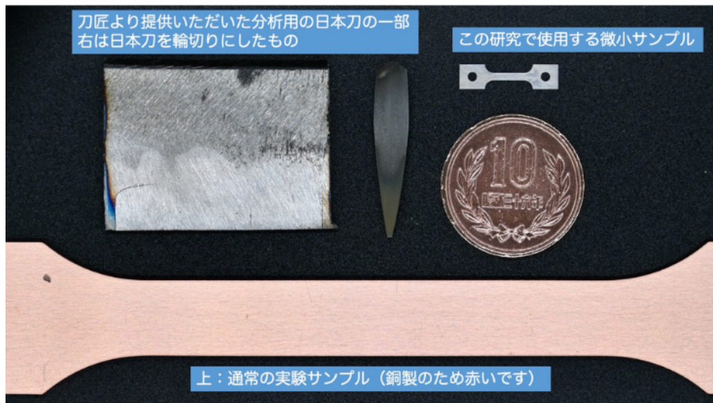
標準的な引張試験用サンプルと本研究で用いる微小サンプル
